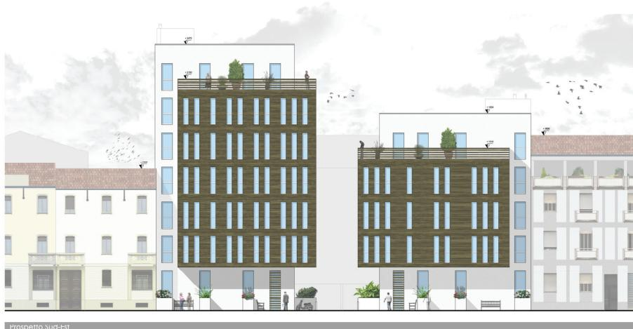
**Figura 10.** Tesi di laurea di Alessandro Tomasi, *Edifici residenziali multipiano in legno a Milano: progetto con la tecnologia X-LAM (2011)*. Prospetti. La tesi prevede la sostituzione di due edifici esistenti con due nuove realizzazioni, che dialogano con il contesto urbano ricomponendo e rinnovando il fronte urbano.
