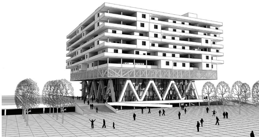
**Figura 1.** Vista del modello dell'edificio. I primi due livelli sono destinati ad attività commerciali, il terzo ospita funzioni terziarie, i successivi residenze.
