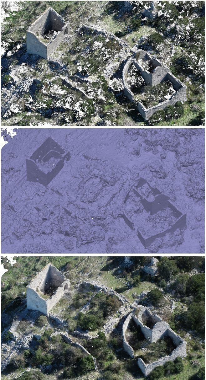
Fig. 8: elaborazione della nuvola fotogrammetrica da drone nelle fasi di dense cloud, mesh e texture.
