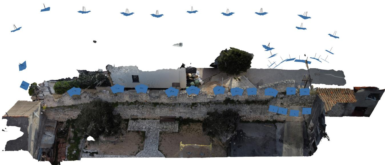
Fig. 6: campagna di acquisizione fotogrammetrica in quota (con mini-UAV). L'immagine evidenzia i punti di ripresa (in blu) che hanno consentito la ricostruzione geometrica del modello fotogrammetrico 3D.
