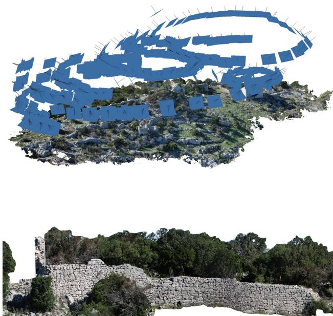
Fig. 6: schematizzazione dei punti di ripresa da drone per la realizzazione della nuvola di punti fotogrammetrica.
