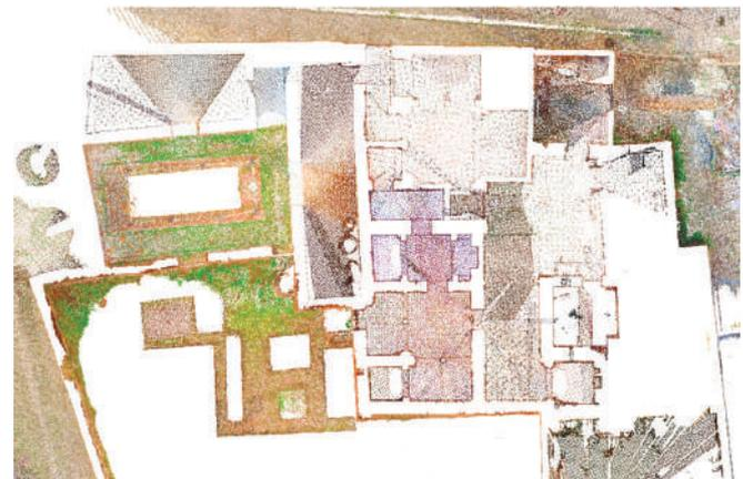
Visualizzazione del dato *point cloud* sezionato tramite uno dei livelli di riferimento planimetrici impostati su *software Autodesk Revit*.
