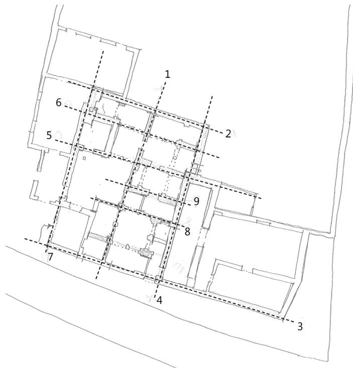
Eidotipo Planimetria con indicazione e codificazione dei setti murari analizzati.
