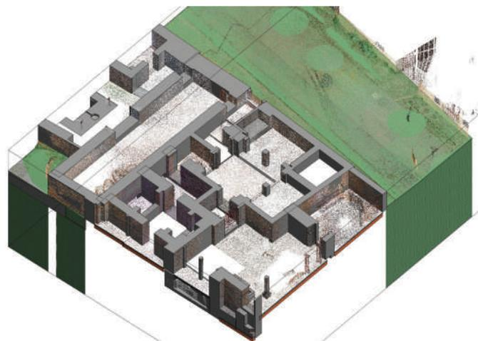
Fasi di costruzione del modello topografico del terreno. In basso, le fasi di selezione dei punti di riferimento per la modellazione e la costruzione della superficie 3D. In alto, l'inserimento e unione del modello architettonico e della superficie topografica del terreno.
