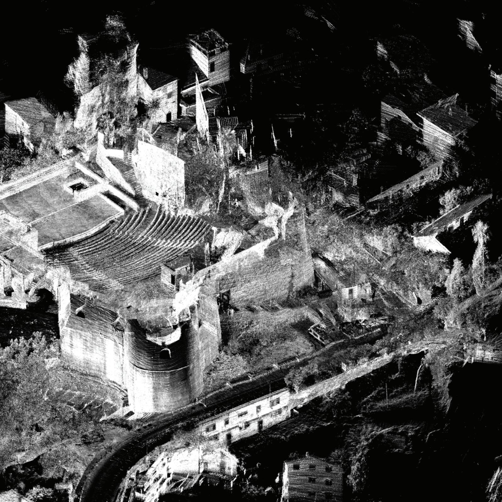
Viste della nuvola di punti complessiva ottenuta dall'integrazione tra dato prodotto da laser mobile e la nuvola di punti fotogrammetrica da drone.
