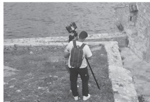
Operatori durante le fasi di posizionamento della strumentazione di ripresa laser.
