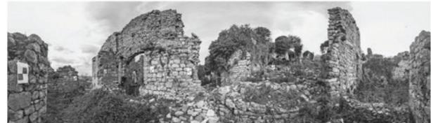
La metodologia impiegata per la lettura e l'interpretazione dell'antica fortezza di Bar si è basata sulla integrazione di metodologie 3D laser scanning e fotogrammetriche digitali. La foto sopra illustra una fotografia sferica dei ruderi di Stari Bar acquisita, in seguito al rilevamento della ruvida di punti, con la fotocamera coassiale integrata ai laser scanner.
