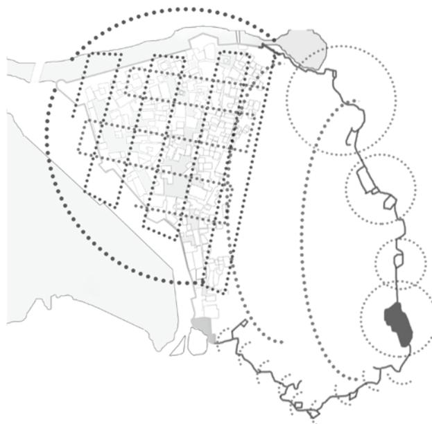
In alto, lo schema di acquisizione per il sistema fortificato di Cattaro. Sono riportate le differenti modalità di sorvolo del drone: circolari, per punti di interesse e lineari o ad archi di cerchio per piani di volo automatici o per modalità di volo manuali.
