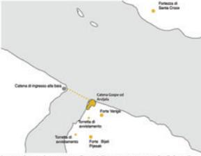
La conformazione orografica dello stretto consentì di installare, all'estremità del canale, una catena che regimava il transito delle imbarcazioni verso il golfo di Cattaro. Tale sistema era previsto di strutture fortificate che, assieme ad altre torri e fortificazioni di modeste dimensioni, disposti sul crinale della collina sovrastante, collaboravano alla difesa della baia.
