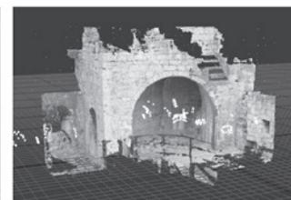
L'acquisizione digitale del Castello con strumentazione laser scanner e fotogrammetrica. A destra, la gestione della nuvola di punti generata dai due sistemi di acquisizione e l'estrapolazione delle informazioni necessarie alla produzione di elaborati 2D e 3D del manufatto.
