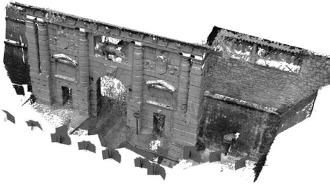
Porta Zara: la fotogrammetria close range da terra permette di acquisire con altissimo dettaglio e precisione metrica la porzione basamentale fino ad un'altezza di circa 3 metri. Oltre quella quota, sono necessari strumenti quali aste telescopiche o droni per inquadrare gli elementi architettonici e le modanature dall'alto e ottenere maggior dettaglio delle superfici.
