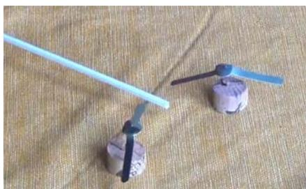
**Fig. 3.** Due versorium orientati da una cannuccia elettrizzata.
