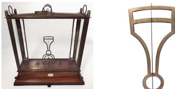
**Fig. 5.** Bilancia di precisione con pinzette per raccogliere i piccoli pesi (inizio 1800), firmata sul giogo da P. Torquato Tasso (Antonio Campana, *Inventario delle macchine esistenti nel Gabinetto fisico della pontificia Università di Ferrara* in Zini 2006, pp. 225-237).
