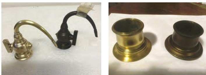
**Fig. 7.** Alcuni elementi d'ottone prima della pulizia e della verniciature (a destra nelle foto) e dopo (a sinistra nelle foto)
