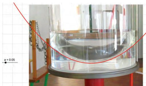
**Fig. 3.** Prova grafica con Geogebra della forma parabolica assunta dall'acqua nel cilindro rotante
