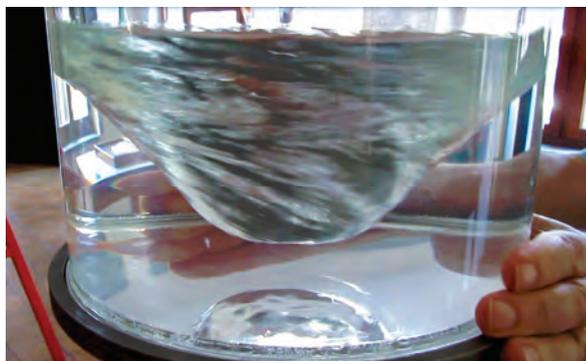
**Fig. 2.** Forma della superficie dell'acqua durante la frenata del cilindro
