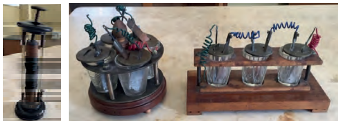
Fig. 8. Sinistra: pila di Volta a colonna. Destra: pile di Volta a tre e a quattro tazze
