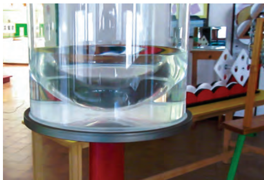
Fig. 1. La concavità acquisita dall'acqua nel cilindro rotante del nostro "Secchio di Newton"
