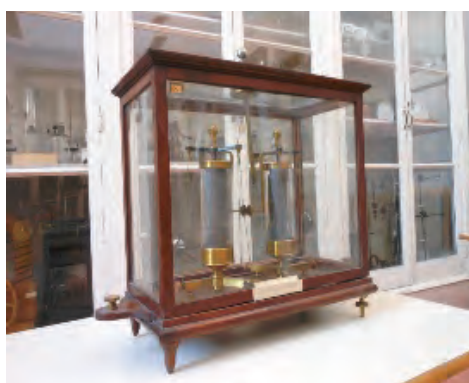
Fig. 4. Elettrometro a campo ausiliario di Bohnenberger
