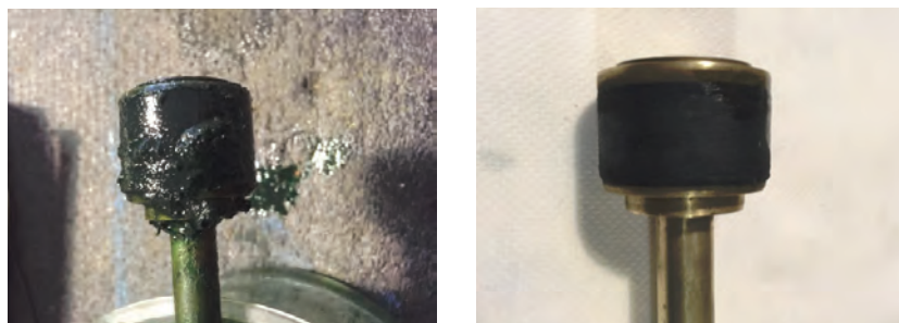
Fig. 6. Uno dei pistoni prima della pulizia (sinistra) e dopo (destra)
