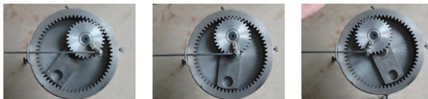
Fig. 5. Realizzazione dell'exhibit del meccanismo di Tusi
