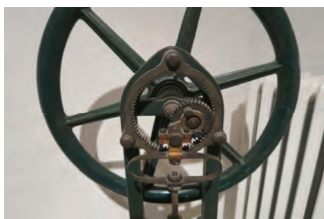
Fig. 7. Macchina pneumatica di Delehuil (Museo del Gabinetto di Fisica, Università di Urbino)
