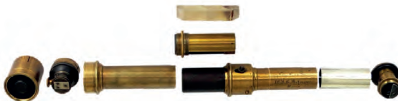
Fig. 4. Lo strumento scomposto nelle sue parti principali: si notano la fenditura, il collimatore (spoglio del rivestimento in pelle), il gruppo formato dai cinque prismi (in alto) e l'ottica di osservazione con l'oculare Ramsden munito di scala graduata; sui due prismi di vetro flint è graffiata la data 1876.
