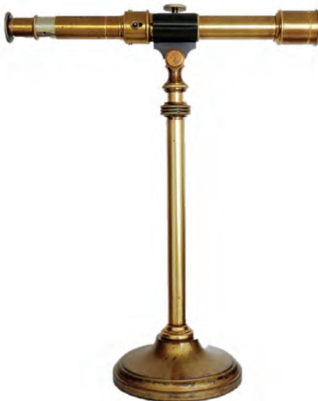
Fig. 3. Lo spettroscopio de poche su piedistallo, lunghezza 220 mm, diametro massimo del tubo 26 mm (collezione dell'autore).
