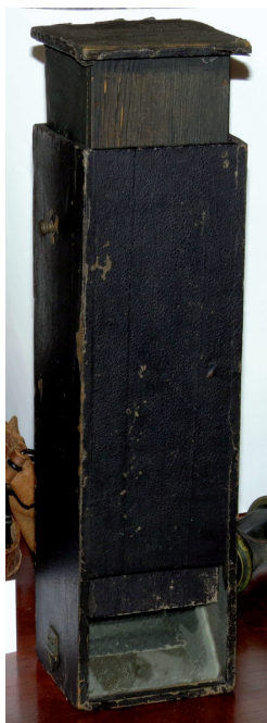
Fig. 9. Modello originale di periscopio in legno costruito con due prismi rettangolari scorrevoli l'uno dentro l'altro, con due specchi montati a 45^\circ per la visione, al riparo nelle trincee, del territorio circostante. Lo sviluppo successivo portò l'applicazione delle ottiche da cannocchiale e prismi ottici a cristallo sia per visioni monoculari che binoculari, poi usati nella Seconda Guerra Mondiale
