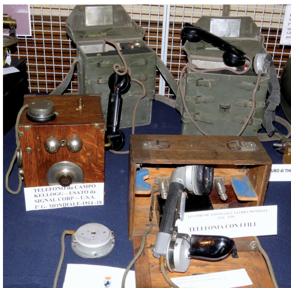
Fig. 8. Gruppo di telefoni da campo di varie nazionalità. Sulla destra, di fronte, un raro esemplare di telefono da campo in cassetta dell'esercito Austro-Ungarico del 1917, avente la cornetta ed un auricolare d'ascolto supplementare; targhetta di costruzione della Ericsson ma costruito in Ungheria. Alla sinistra, un raro esemplare di telefono da campo Kellogg costruito in U.S.A. (1915) in dotazione ai Signal Corps U.S.A. nella Prima Guerra Mondiale, con un solo auricolare e microfono. Dietro, coppia di telefoni da campo della Face Standard di Milano in contenitori di cuoio da trasporto a spalla, corredati di cornetta ed auricolare supplementare in bachelite; questo modello, degli anni 1920-30, è stato costruito ed usato fino alla Seconda Guerra dall'Esercito Italiano
