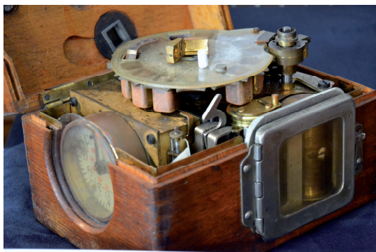
Fig. 1. Macchina ad orologeria per timbratura del luogo ed orario di arrivo e di partenza del messaggio affidato al piccione viaggiatore. Visibile, sopra la macchina, un piccolo rotolo di carta che alloggiava nella apposita scatola in ottone per il trasporto
