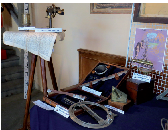
Fig. 13. Strumenti per misurazione dei terreni e cartografia militare. Sono rappresentati alcuni dei principali strumenti per rilevamento (tavoletta pretoriana, squadra agrimensorio, teodolite, clisimetro, inclinometro) e strumenti per misure e disegno (set di compassi vari per uso militare, grande compasso a verga, riga e squadra per mappe, goniometro circolare per mappe, carta geografica dell'IGM)
