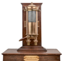
Fig. 3 Salinometro e telegrafo delle macchine (“Museo del mare di Bagnoli”)
