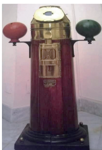
Fig. 2 Chiesuola di bussola (“Museo Navale dell’Università Parthenope”)
