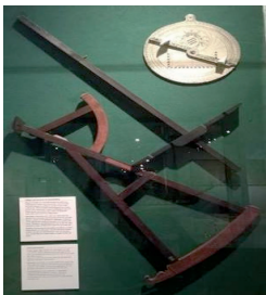
Fig. 1. Balestriglia ed astrolabio (Copenaghen Orlogmuseum)
