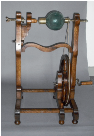
Figg. 5.1.-5.2. Macchina di Cartesio e Bulfingero per dimostrare l’azione delle forze centrali, 1/4 XIX Secolo
