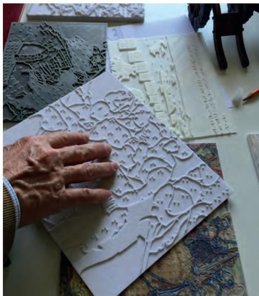
**Figura 13.** Alcuni esempi di versioni tattili degli arazzi, stampati in 3D con materiali diversi, in versione monocromatica e a colori (per ipovedenti).
